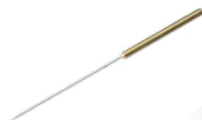
**Aguja de penetración, materiales bituminosos**
