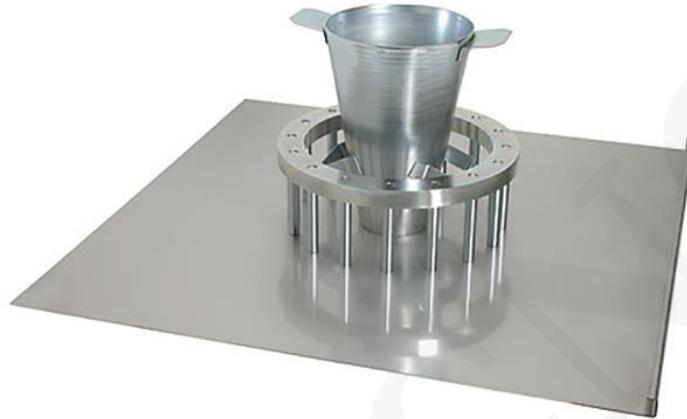
La prueba del anillo en J se utiliza para determinar la capacidad de paso, la dispersión del flujo y el tiempo de flujo  $t$  del hormigón autocompactante 500 a medida que el hormigón fluye a través del aparato
