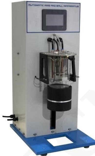
El aparato automático de anillo y bola consta de un calentador, sistema de elevación eléctrico y agitador magnético con control de velocidad, sistema de barrera con sensor óptico, controlado por microprocesador y pantalla grande con panel táctil, 2 bolas de acero, guía de centrado de bola, 2 anillos de latón, vidrio de 600 ml. vaso de precipitados y máx. Termómetro 110 ° C.
