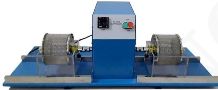
Este equipo ha sido desarrollado para evaluar la durabilidad de la roca al debilitamiento y desintegración cuando se somete a los efectos simulados de apagamiento climático.
