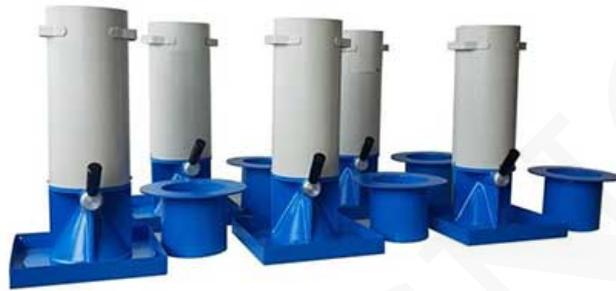
Se utiliza para determinar la densidad del suelo compactado de grano fino.
