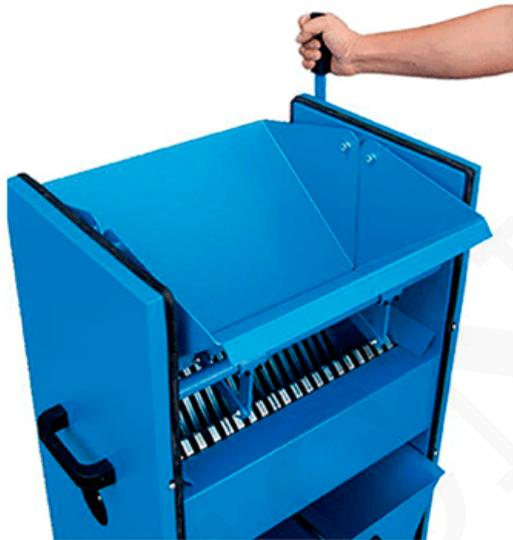
El divisor de muestras de gran capacidad se utiliza para obtener las muestras representativas en la cantidad requerida para las pruebas relacionadas de las partes de agregados que llegan al laboratorio.
