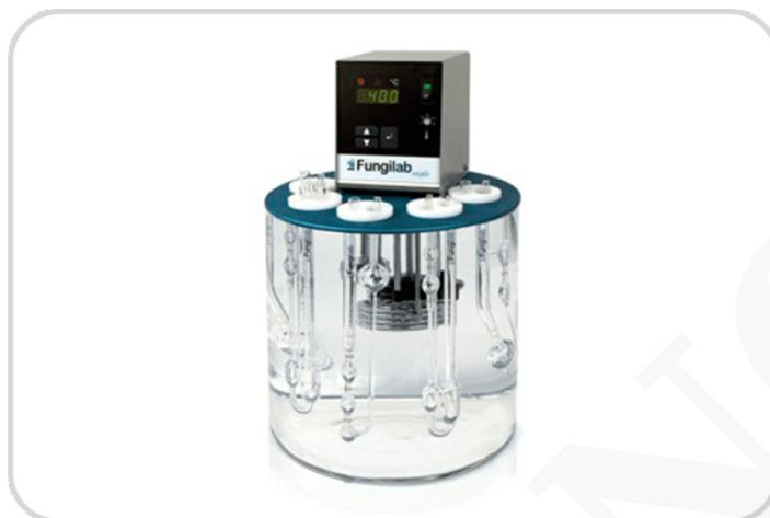
Baño de precisión, controlado por temperatura para viscosímetros capilares.
