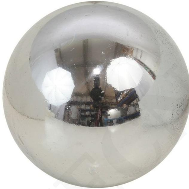
Bola de ensayo Ø 9,5 mm.
