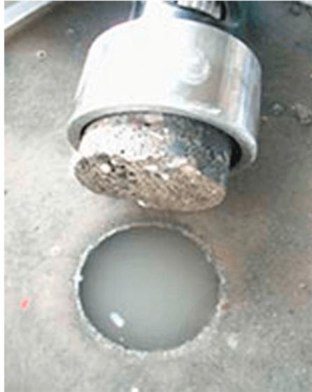
Se utiliza para realizar una prueba de extracción de acuerdo con ASTM C1583, "Método de prueba para la resistencia a la tracción de superficies de concreto y la resistencia a la adherencia o resistencia a la tracción de los materiales de reparación y recubrimiento de concreto por tensión directa (Método de extracción) . " La resistencia al arranque obtenida
