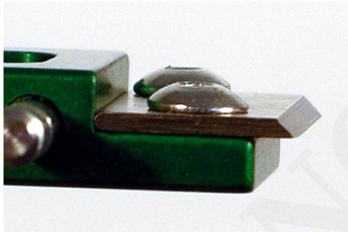
Todos los siguientes bordes de cuchilla se adaptarán a todos los modelos de extensómetros Epsilon que utilizan bordes de cuchilla. Las excepciones son las unidades de alta temperatura que usan varillas de cerámica, extensómetros especiales que requieren contactos puntuales cónicos, extensómetros de asfalto, calibradores con clip y deflectómetros.
