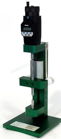
El calibrador axial / torsional de Epsilon presenta una resolución de 0.001 mm (50 microinches) y tiene 50 mm (2 pulgadas) de rango de medición de rotación axial y torsional donde 1.27 mm (0.050 pulgadas) de movimiento lineal equivale a un ángulo de giro de 1 °. El botón autocero y la pantalla digital simplifican enormemente la calibración de extensómetros. El calibrador 3590AT está diseñado para usarse con los extensómetros axiales / torsionales modelo 3550, 7650 y 3550HT.
