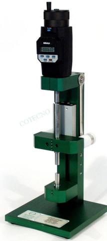
El calibrador estándar de Epsilon presenta una resolución de 0.001 mm (50 microinches) y tiene un rango de medición de 50 mm (2 pulgadas). El botón autocero y la pantalla digital simplifican enormemente la calibración de extensómetros. El calibrador 3590 es útil para la calibración y verificación del extensómetro con sistemas de prueba.
