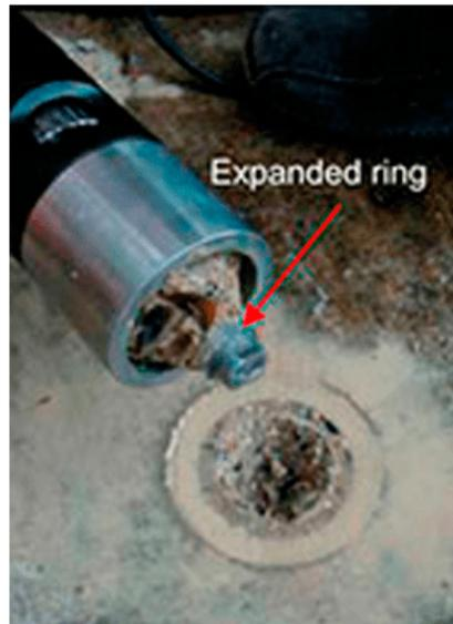
Permite realizar pruebas de extracción en estructuras existentes sin la necesidad de preinstalar insertos. CAPO-TEST provee un sistema de extracción similar al sistema LOK-TEST para estimados certeros de la resistencia a compresión en el lugar.
