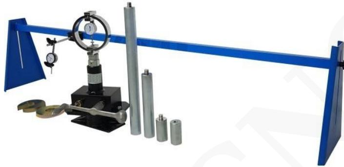
Se utiliza para determinar de manera rápida y eficiente la capacidad de carga de los suelos en construcciones de carreteras, cimientos, subgrados de carreteras, etc.
