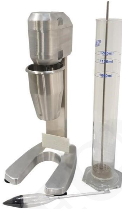
El equipo para medir la textura del suelo se suministra con agitador de alta velocidad, hidrómetro 152 H de rango de -5 a 60 g / l, cilindro de Bouyoucos, 1205 ml y varilla agitadora de acero inoxidable.
