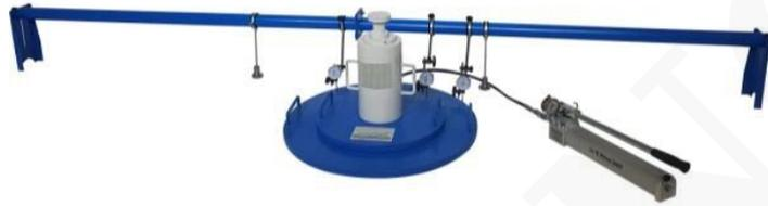
Esta prueba se realiza para la determinación de la capacidad portante de un suelo in situ en construcciones de carreteras, cimientos, subrasantes de carreteras y pavimentos de carreteras y aeropuertos.
