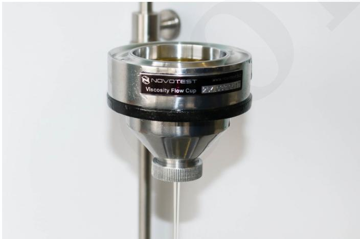
Para facilitar su uso, Viscosity Flow Cup NOVOTEST VZ se puede equipar con un soporte especial, que se utiliza para ajustar el nivel y la altura de la taza.
