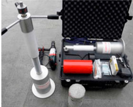
Es un extractor de muestras portátil de peso ligero para obtener rápidamente núcleos perforados que sean precisos de diámetro, tienen lados rectos, y son perpendiculares a la superficie. Además de determinar la resistencia a la compresión en el lugar
