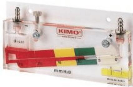
El manómetro de columna de líquido inclinado CP 25 de Kimo mide ligeras variaciones de presión, depresión o presión diferencial de aire o gas. Está especialmente diseñado para controlar la obstrucción de los filtros en las cabinas de pintura.
