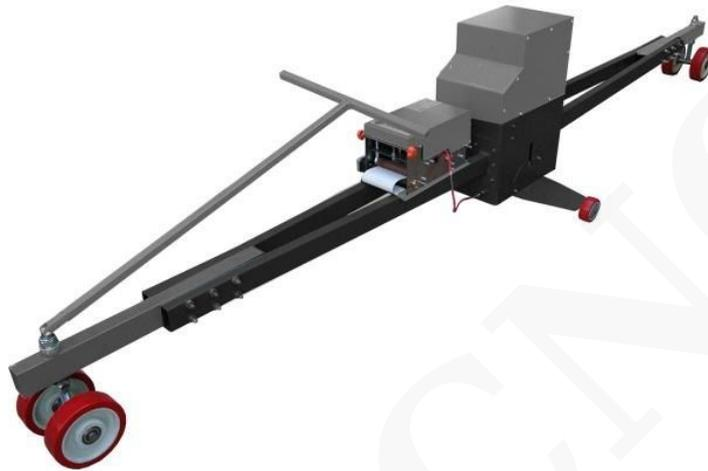
El dispositivo de haz móvil de grabación autográfica de 3 metros de largo se utiliza para comprobar si hay irregularidades en las superficies de carreteras de hormigón y bituminosas. Una unidad de detección que comprende una rueda conectada a un indicador proporciona un aumento de 4: 1.
