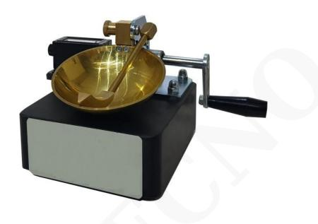
Se usa para evaluar la relación entre el porcentaje de humedad de una muestra de suelo y el número de golpes necesarios para cerrar una ranura hecha en el suelo; y por lo tanto, para determinar cuándo un suelo arcilloso cambia de un estado plástico a un estado líquido.
