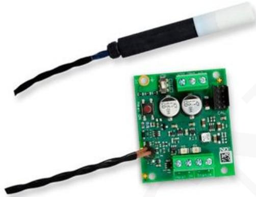
El módulo EE1900 está diseñado para una medición altamente precisa de la humedad relativa (HR) o la temperatura del punto de rocío (Td) en cámaras climáticas y otras aplicaciones exigentes. El sensor de humedad es particularmente resistente al polvo y agentes corrosivos y funciona incluso en ambientes químicamente contaminados.
