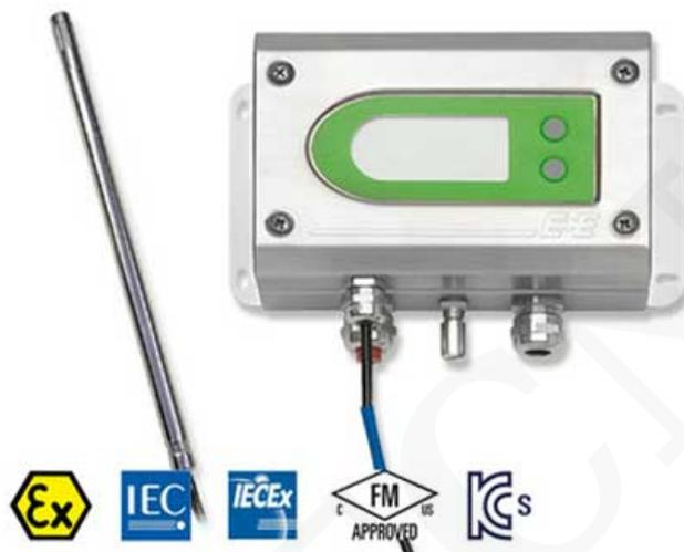
El transmisor de humedad y temperatura EE300Ex está dedicado a la medición en áreas con peligro de explosión. Cumple con las clasificaciones para Europa (ATEX), Internacional (IECEX), EE. UU. / Canadá (FM) y Corea (KC) y puede emplearse en áreas de peligro de explosión de gas y polvo. El EE300Ex intrínsecamente seguro se puede instalar en el área de peligro de explosión incluso en las zonas 0/20 (División 1).
