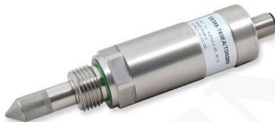
El transmisor de punto de rocío EE355 compacto con un rango de medición de hasta  $-60^{\circ}\text{C}$  ( $-76^{\circ}\text{F}$ ) Td y una excelente relación precio / rendimiento está dedicado a aplicaciones en sistemas de aire comprimido, secadores de plástico y procesos de secado industrial.
