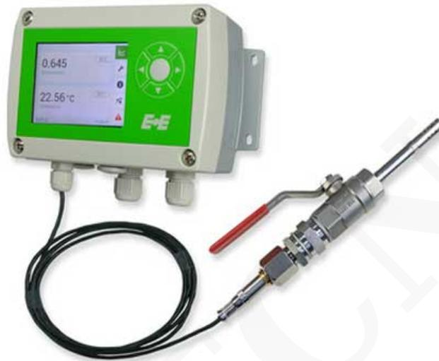
El diseño de la carcasa facilita el montaje y el mantenimiento fáciles . EE360 está disponible con carcasa de policarbonato o acero inoxidable IP65 . Los valores medidos están disponibles en dos salidas analógicas y en la interfaz digital opcional RS485 con Modbus RTU o Ethernet con Modbus TCP . Se puede usar un módulo de relés opcional para alarmas y control de procesos.
