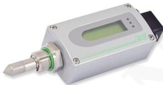
EE371 está dedicado a la monitorización precisa y confiable de la temperatura del punto de rocío (Td) en el rango de -60 ... 60 ° C Td (-76 ... 140 ° F Td), con un índice de presión de hasta 100 bar (1450 psi). Es ideal para sistemas de aire comprimido y control de procesos industriales. Además de Td, el dispositivo mide también la temperatura del punto de congelación (Tf) o la concentración de volumen (Wv).
