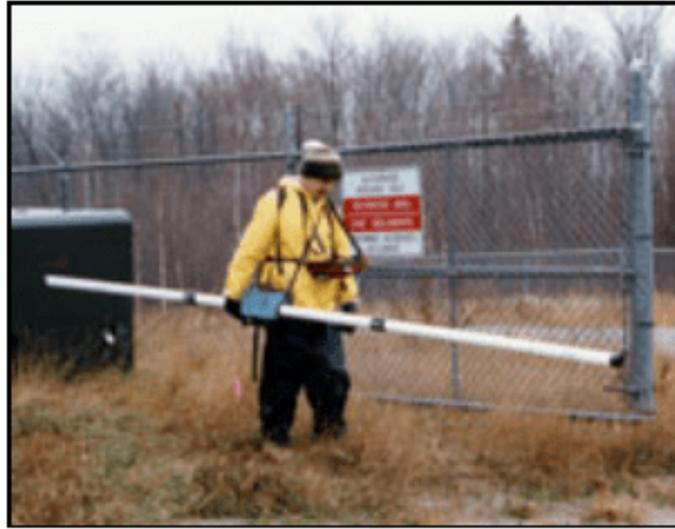
El EM31-MK2 mapea variaciones geológicas, contaminantes de aguas subterráneas o cualquier característica subsuperficial asociada con cambios en la conductividad del suelo. Usando una técnica inductiva electromagnética patentada que permite mediciones sin electrodos o contacto con el suelo. Con este método inductivo, se pueden realizar levantamientos en la mayoría de las condiciones geológicas, incluidas las de alta resistividad superficial, como arena, grava y asfalto.
