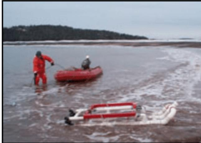
Para operar en ambientes marinos, el EM61S es un sistema de bobina y cable completamente sumergible capaz de sumergirse a profundidades de más de 60 metros.
