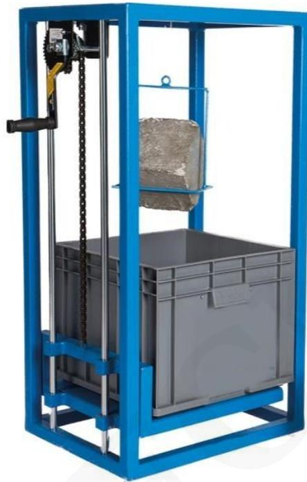
Se utiliza junto con una balanza electrónica adecuada para la determinación de la gravedad específica de concreto y agregados frescos y endurecidos.
