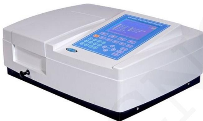
El espectrofotómetro B011401010900 equipado con una pantalla LCD de 6 pulgadas, es un instrumento analítico ideal y avanzado para que el laboratorio realice escaneo de longitud de onda, prueba de cinética, funciones de longitud de onda múltiple. Todas las funciones se pueden operar en espectrofotómetro y se pueden leer directamente en la pantalla.
