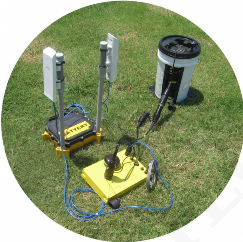
DAQlink con dos antenas Wi-Fi direccionales
