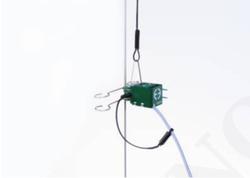
Modelo 3442 que realiza pruebas de tensión de alambre; Longitud de calibre de 0.25 " y rango de medición de \pm 0.05 " ( \pm 20\% de deformación)
