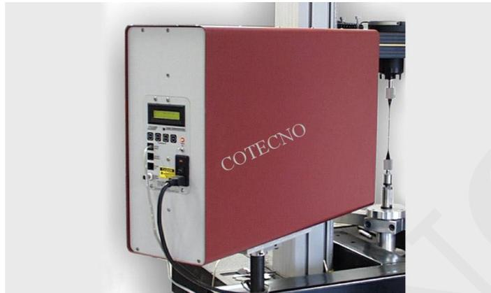
Los extensómetros modelo LE-05 y LE-15 miden la tensión ópticamente, sin entrar en contacto con la muestra, utilizando tecnología de diodo láser. Los extensómetros son autónomos y portátiles. Pueden interactuar con una variedad de máquinas de prueba y sistemas de adquisición de datos utilizando la salida analógica de  $\pm 10$  V o el puerto serie RS-232 bidireccional. La operación puede ser local o remota. Se incluye una pantalla digital.
