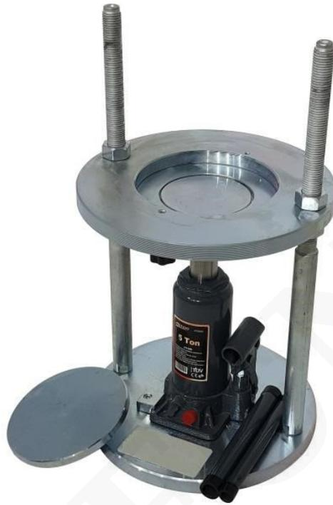
Se usa para extruir muestras con diá. 4 ", 6", 100 mm y 150 mm. Por lo tanto, puede extruir muestras CBR, Marshall y Proctor.
