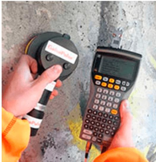
Se utiliza para medir la velocidad de corrosión del refuerzo en el concreto
