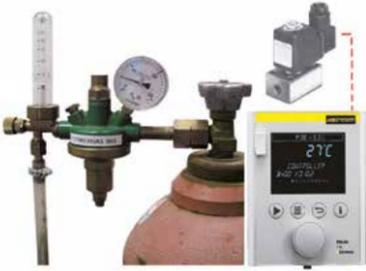
Válvula reductora de presión con medidor del volumen de paso Gases protectores
