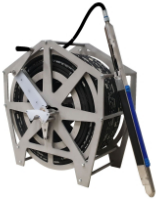
Fuente de perforación de SH y P wav...
