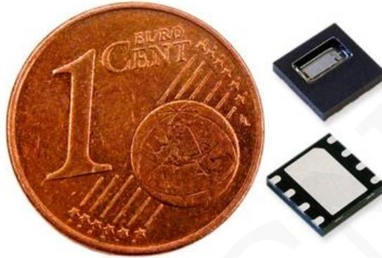
El sensor de humedad y temperatura HCT01 combina tecnología de sensor de película delgada probada a largo plazo de alta calidad con la facilidad de trabajo más fácil y una integración rentable del sensor de humedad en su aplicación.
