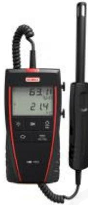
El termohigrómetro de mano HD 110 de Kimo mide la humedad relativa, la temperatura y el punto de rocío.
