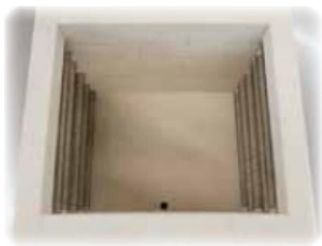
Los elementos calefactores en los tubos soporte aseguran una libre difusión del calor
