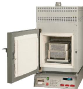
El horno de contenido de asfalto (horno NCAT) determina automáticamente el contenido de asfalto de las mezclas de pavimentación. Desarrollado por NCAT, el Centro Nacional de Tecnología del Asfalto, este horno es un método rentable y respetuoso con el medio ambiente para la determinación precisa del contenido de asfalto. Elimina los problemas de costo y seguridad que conlleva el uso de solventes y la eliminación de solventes plagada de otros métodos.
