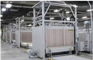
**Horno con dispositivo de elevación superior H 3630/LT DB200**
