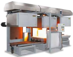
**Instalación con dispositivo de elevación superior H 245/LTS con unidad refrigeradora y dispositivo de intercambio de mesas**
