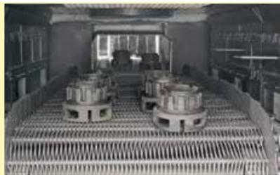
Banda transportadora de malla en horno continuo
