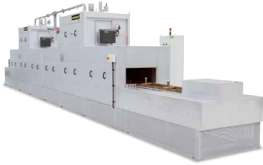
Horno continuo D 700/10000/300/45S con cadena de transporte para 950 °C, calentamiento por gas
