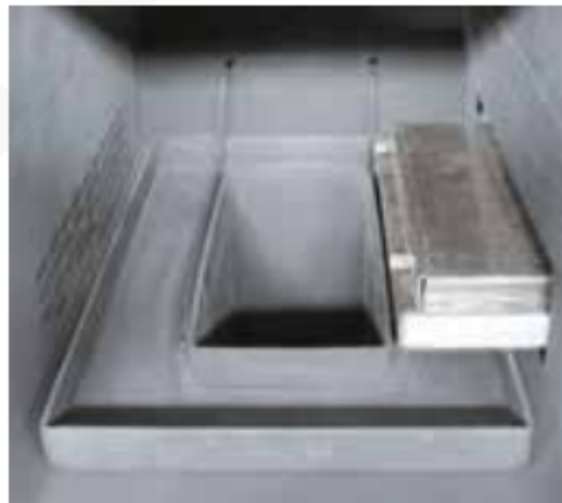
Horno de baño salino TS 4/50, calentamiento eléctrico
