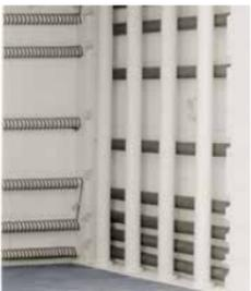
**Inyección de aire precalentado a través de tubos cerámicos perforados**
