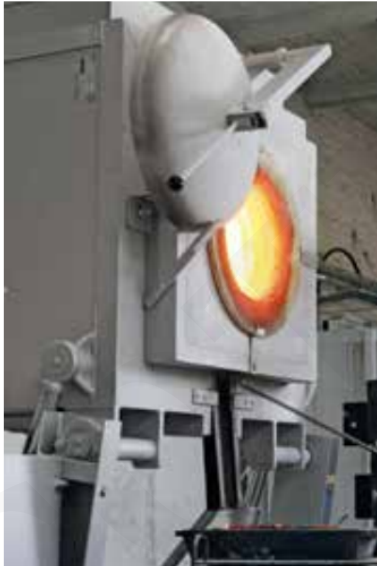
Carga del cazo de transporte con un horno de crisol
