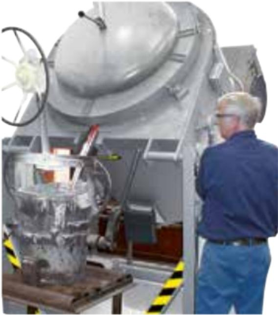
Horno de crisol basculante KB 240/12 para la fundición
