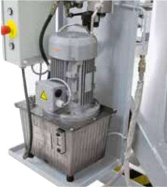
Grupo hidráulico con líquido hidráulico difícilmente inflamable
