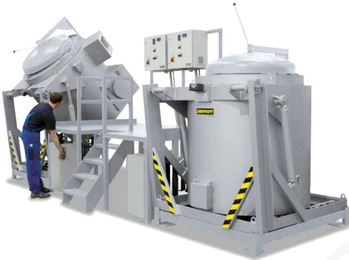
Planta de hornos de fusión, compuesta por dos hornos de crisol basculante
