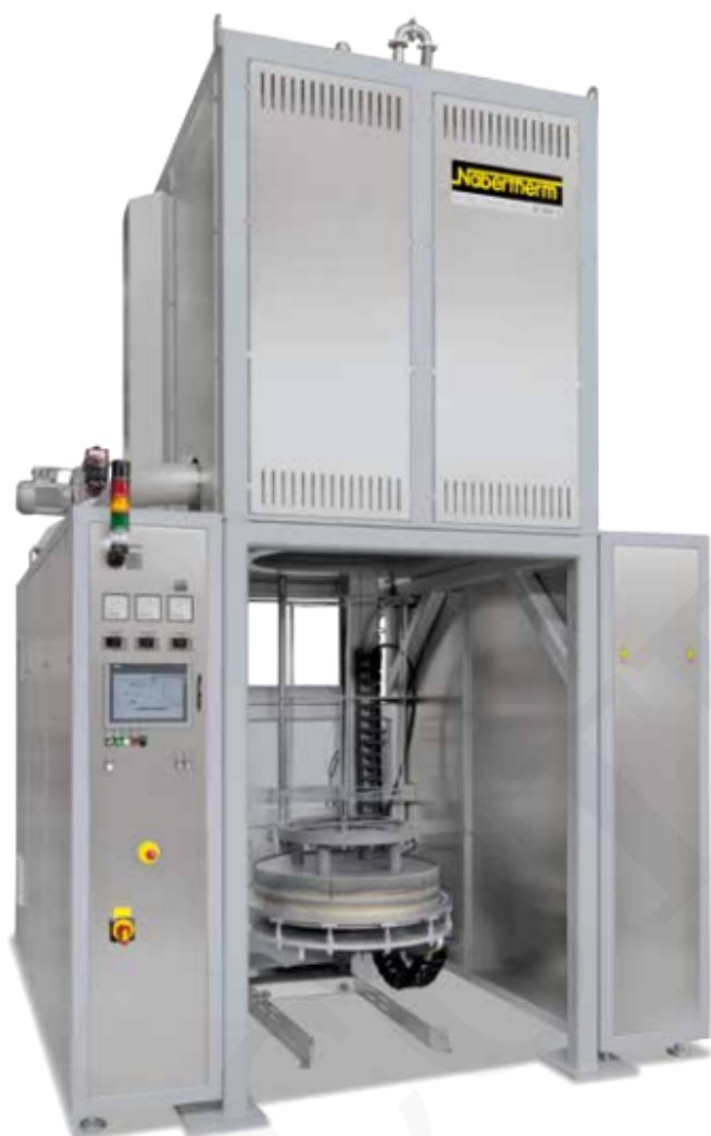
Horno de retorta de base elevable LBR 300/11 H 2 con técnica de seguridad para el funcionamiento con hidrógeno como gas de proceso
