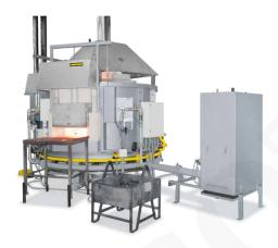
para el precalentamiento de moldes para dos mazos de forja
