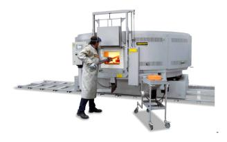
Horno de solera giratoria DH 3020/1480/450/11, desplazable sobre carriles
